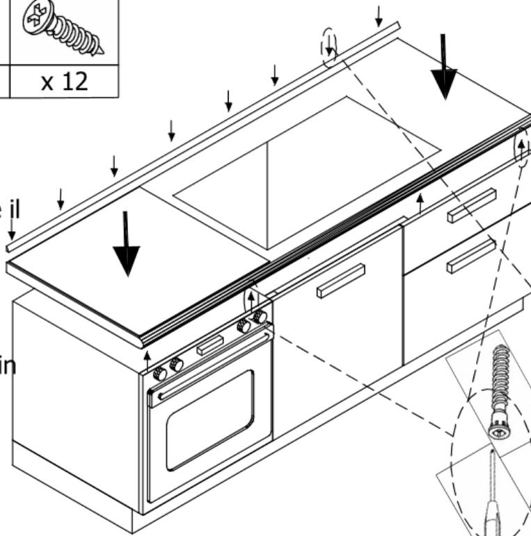
Sfilare il foglio di alluminio dell'alzatina e fissare la stessa al top. Infilare il foglio di alluminio, una volta fissata.
